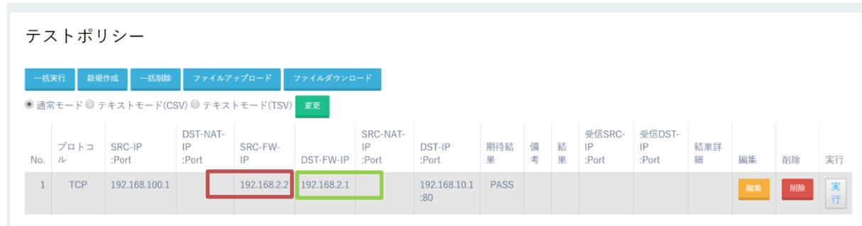
(3) この設定を行うことで、FirewallTesterのSRC-FW-IPの設定されたインターフェースからDST-FW-IPの設定されたインターフェースに向けて試験パケットを送信します。IPアドレスは任意のアドレスを使用することができます。
