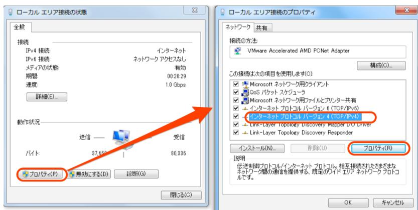
「インターネットプロトコルバージョン4(TCP/IPv4)のプロパティ」 ウィンドウが開きますので、「次のIPアドレスを使う」を選択し、IPアドレス欄には「192.168.100.2」、サブネットマスク欄には「255.255.255.0」を入力します。IPアドレスとサブネットマスクを入力したら、「OK」ボタンをクリックします。
