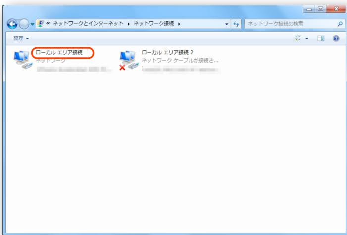
IntraGuardian2+ が接続されているネットワークアダプタをダブルクリックします。
