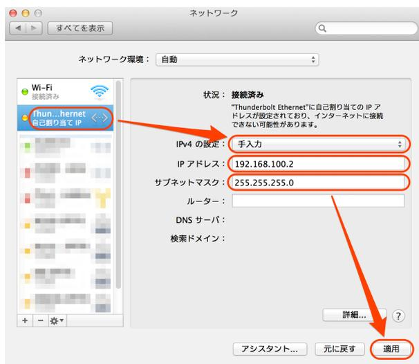
IntraGuardian2+を接続しているネットワークインタフェースを選択し、IPv4の設定を「手入力」、IPアドレスを「192.168.100.2」、サブネットマスクを「255.255.255.0」と入力します。入力したら「適用」をクリックします。
