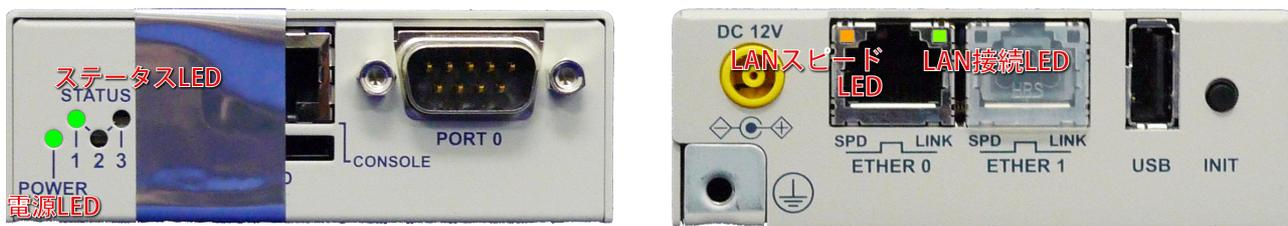
起動後、本製品が正常に動作している時、各LEDは次のようになります。
